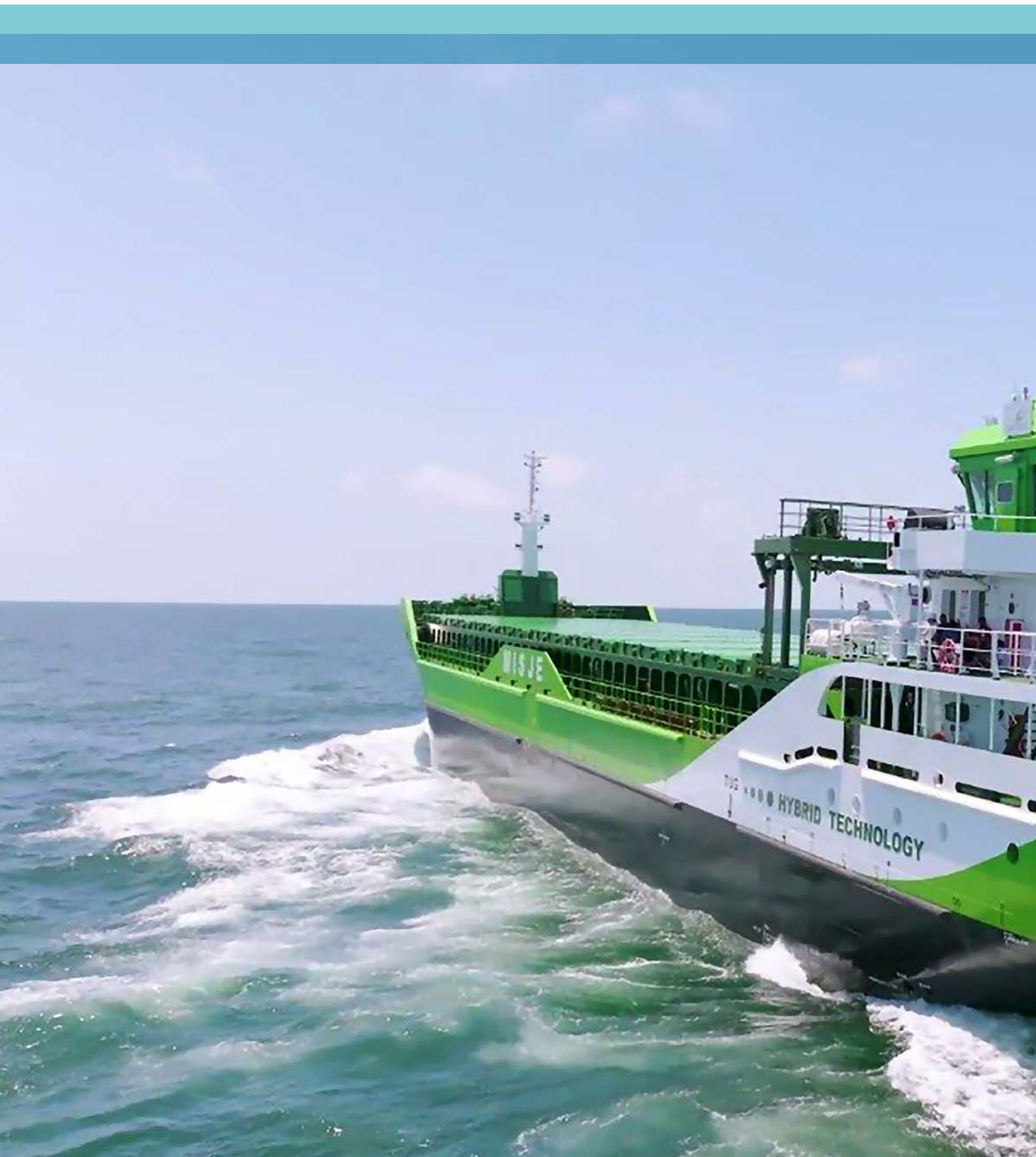
Misje fikk i fjor levert sitt første av ti Eco Bulk fartøy, «Misje Vita». Skipene bygges med hybrid fremdriftssystem og er designet for å konverteres til nullutslipp. FOTO: MISJE REDERI AS
